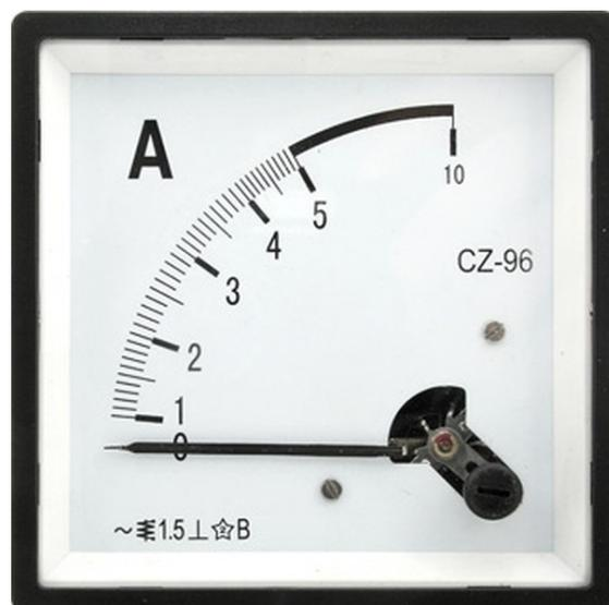
Рис. 6. Амперметр переменного тока электромагнитной системы
