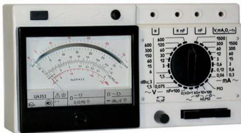
Рис. 4. Ампервольтметр Ц4353
