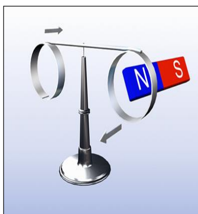
Рисунок 3 – Опыт с алюминиевыми кольцами
