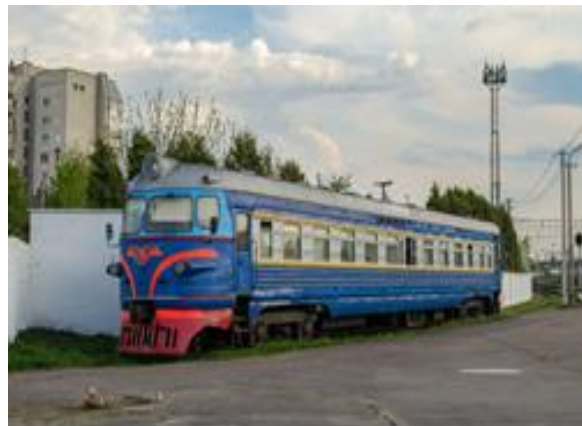
Рис. 6 - Автомотриса (самоходный вагон с двигателем внутреннего сгорания)
