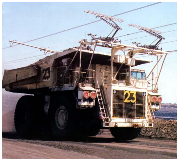
Рис. 4 – Автомобиль-троллейвоз для работы в карьерах – слябовозы для горячих слабов и заготовок грузоподъемностью 64 т (рис. 5);
