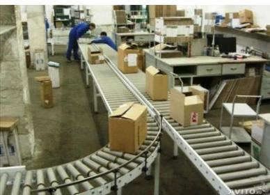
н) рольганг (роликовый конвейер)
