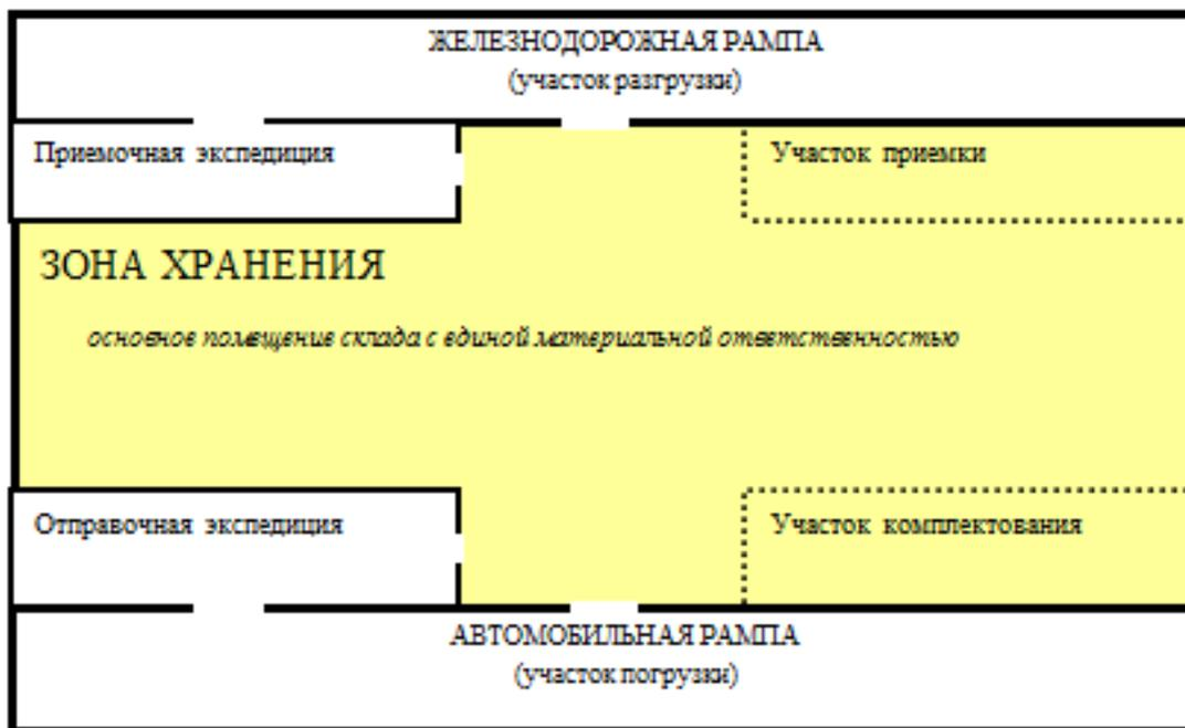
Рис. 1 – Примерная схема склада
