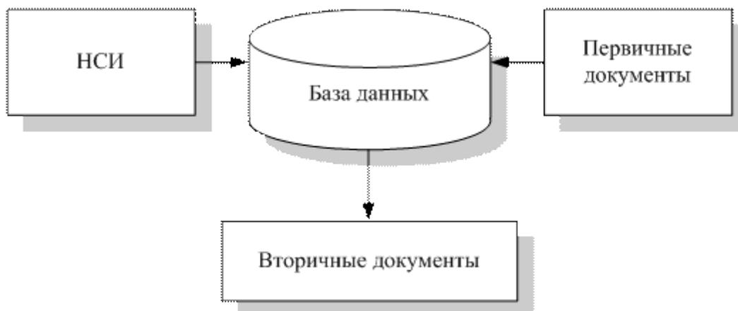
Рисунок 5.2-Изменение схемы формирования документов при использовании информационных технологий
