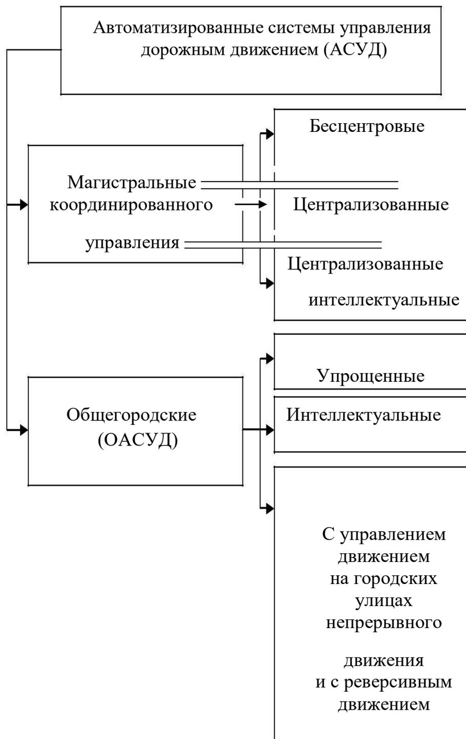
Рис. 1. Классификация автоматизированных систем управления дорожным движением
